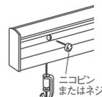
②レールにサイドキャップを付け、穴すべてにニコピンまたはネジを差し込みます。その後カバーを取り付けます。
