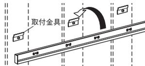
取付金具をネジで取り付け、サイドキャップを付けたレールを上からかぶせて取付金具にしっかりと引掛けます。
