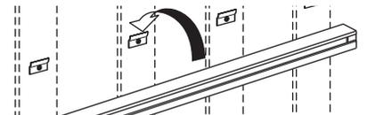
間柱の位置を探し、そこに取付金具をネジで取り付けます。レールを上からしっかりと取付金具に引掛けます。上がり止めとして、レールを壁にネジで固定してください。
