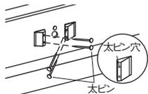
取付位置にて、取付止め用穴から太ピンでレールを固定します。太ピンを太ピン穴に打ち込み固定します。
