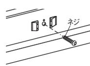
取り付け位置に合わせて、穴からネジでレールを壁に固定します。
