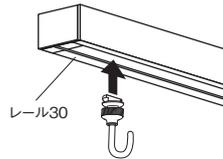
①レール取付部が横側に来るようにフックを持ち、レール溝に挿入します。
