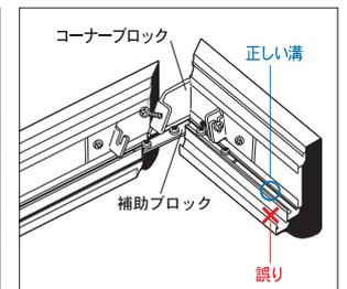
補助ブロックをフレームの正しい溝に挿入して下さい。誤って挿入するとフレームの
