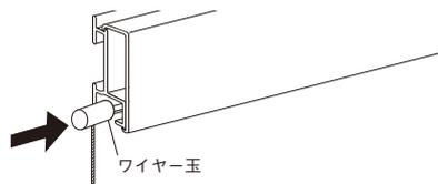
レール下部溝に、ワイヤーフックの先端部分のワイヤー玉を差し込みます。
