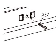
取り付け位置に合わせて、穴からネジでレールを壁に固定します。
