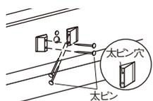
取付位置にて、取付止め用穴から太ピンでレールを固定します。太ピンを太ピン穴に打ち込み固定します。
