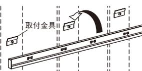
取付金具をネジで取り付け、サイドキャップを付けたレールを上からかぶせて取付金具にしっかりと引掛けます。
