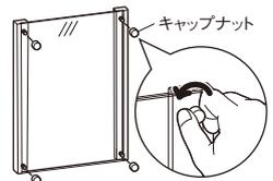
①フレーム前面のキャップナットを外します。
