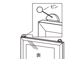
ピンで、壁面に取り付けます。
