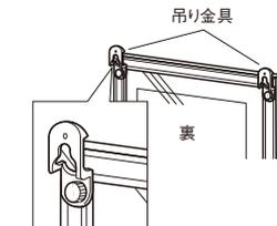
吊り金具をビスで、フレームに取り付けます。
