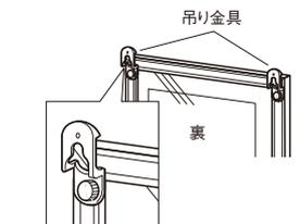
吊り金具をビスで、フレームに取り付けます。
