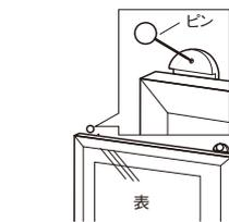
ピンで、壁面に取り付けます。
