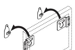
図の様に額吊り金具の穴をフックに引掛けてセットします。
