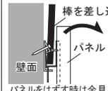
パネルをはずす時は金具とパネルの隙間に直径6mm程度の棒(鉛筆等)を差し込みながら、パネルを取りはずします。
