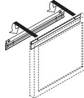
壁面取付金具の溝に額取付金具を差し込み、額をセットします。
