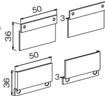
隙間6mmの超薄型。横スレストッパー付きです。
