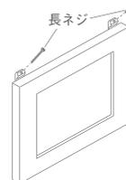
①フレーム裏側上辺に額止め具ミニを短ネジで取り付けます。
